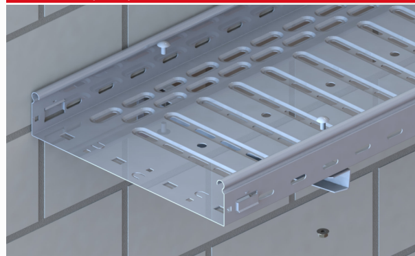
Pričvršćivanje nosača kablova za konzolu vrši se torban vijcima PEKOM M6x12 i nazubljenim maticama M6
